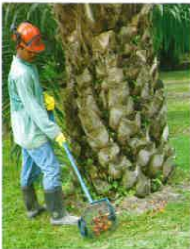
Rajah 3. Penggunaan Roller Picker dapat memudahkan kerja mengutip buah relai.
