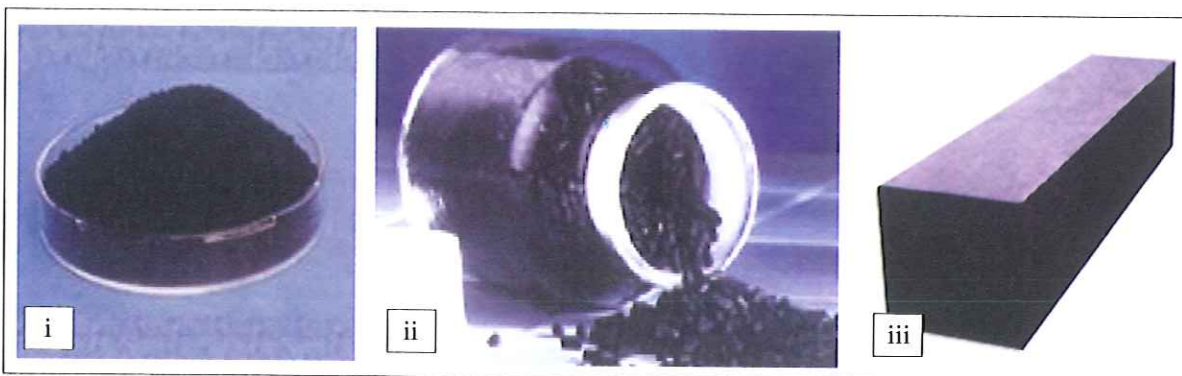
Rajah 3. Produk (i) serbuk, (ii) granul karbon teraktif, dan (iii) bongkah karbon.
