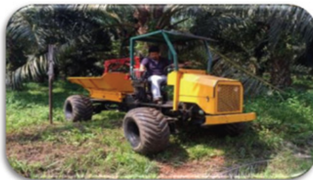
Rajah 1. "Hydra Porter" yang direka untuk mengatasi masalah pergerakan di kawasan tanah lembut.
