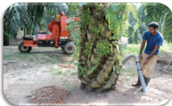
Rajah 2. "LFC" yang direka untuk megutip biji relai.
