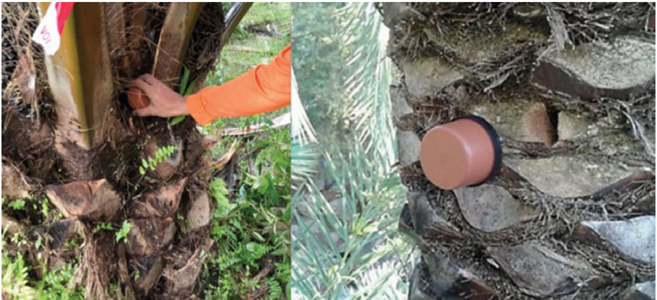
Rajah 5. Alat sensor IoTree yang digunakan sebagai alat pengesan RPW di pokok sawit.
