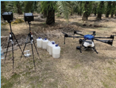
Rajah 3. Peralatan dron untuk semburan produk biopestisid Bt untuk kawalan ulat bungkus.
